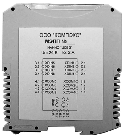
Рис. 22. Модуль эквивалентов пиропатронов МЭПП
